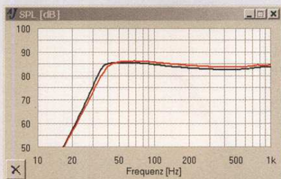
Tiefton-Simulation mit Vorwiderstand 0,2 Ohm (rot) und 1,0 Ohm (schwarz)
