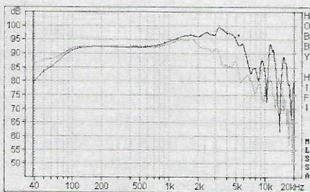
Schalldruck-Frequenzgang in unendlicher Schallwand axial und unter 30° Hervorragend linear bis deutlich über 2 kHz, kaum Resonanzen oberhalb des Linearbereichs.
