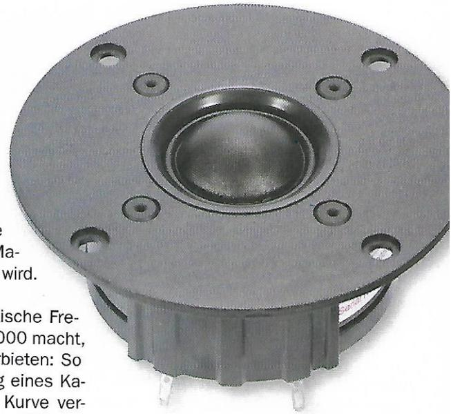
(1/2014) kommt der D2905/970000 ohne Ferrofluid im Magnetspalt aus. Deshalb spielt er im Bereich um seine Resonanzfrequenz deutlich kräftiger. An den Klirrpplots fällt auf, dass nur beim Ferrofluid-freien Hochtöner die Klirrkomponenten optimal gestaffelt sind, vom kräftigeren K2 über den zurückhaltenderen K3 bis zum fast verschwindenden K5.
