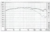
Sehr linear und extrem breitbandig, sehr gleichmäßiges Rundstrahlverhalten.
